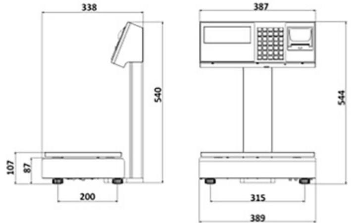
Abmessungen in mm gewicht: 11,6 Kg
